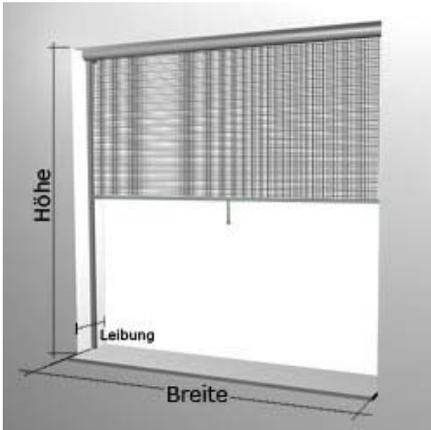
Das Insektenschutzrollo wird von außen in der Laibung des Mauerwerks seitlich montiert. Geeignet für Insektenschutzrollo **Typ 1 und Typ 3**.
