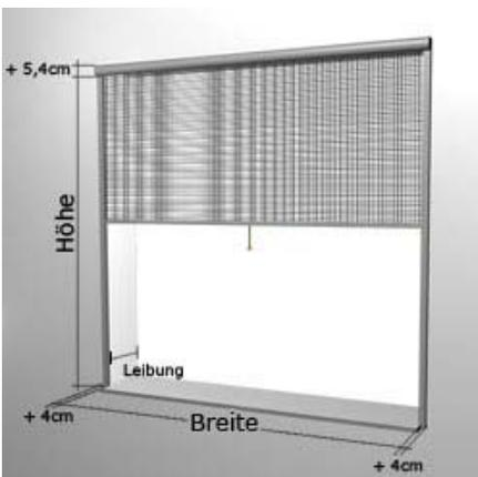
Das Insektenschutzrollo wird von außen vor der Fensterlaibung montiert. Geeignet für Insektenschutzrollo **Typ 1 und Typ 3**.
