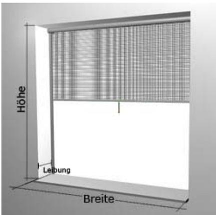
Das Insektenschutzrollo wird von außen direkt auf dem Fensterrahmen montiert. Geeignet für Insektenschutzrollo **Typ 3**.
