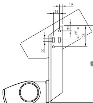
Wählen Sie bei Decken- und Dachsparrenmontage die Positionen der Konsolen so, dass die Vorderkante der Markise mindestens 50 mm hinter der Balkenkante bzw. Dachrinnenkante liegt.
