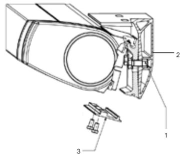
Muttern (1) in Deckenkonsole (2) einlegen
