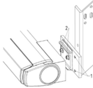
Winkel mit Platte verschrauben. M 12 x 30 (1)
