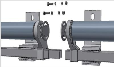
Anlagen in Konsolen einfahren und zusammenstoßen, danach beide Anlagen in den Konsolen befestigen.
