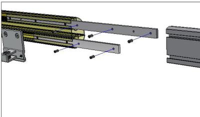
Vor dem Verbinden der beiden Ausfallprofile die Anlagen ausfahren und überprüfen / einstellen der gleichen Neigung beider Anlagen. Dann die beiden AFP-Verbinder wie auf dem Bild dargestellt einführen und diese mittels den 10 Gewindestiften M6x12 sichern.
