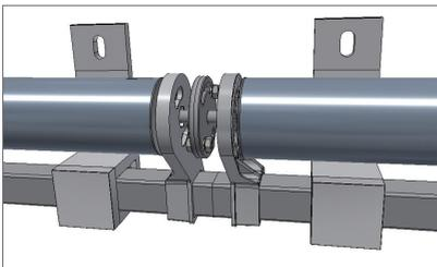
Anschließend Verbindungsrohr mit einer Blindniete in das 2. Tragrohr nieten (im ersten Tragrohr ist dies bereits Lieferzustand), und die beiden Wellen mit den beiden Schrauben M8x20 in den Langlöchern verbinden, sodass die Kedergasse der Tuchwellen an gleicher Position liegen.
