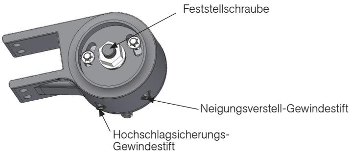
Dann die Feststellschraube lösen (nicht komplett abschrauben!!!!)
