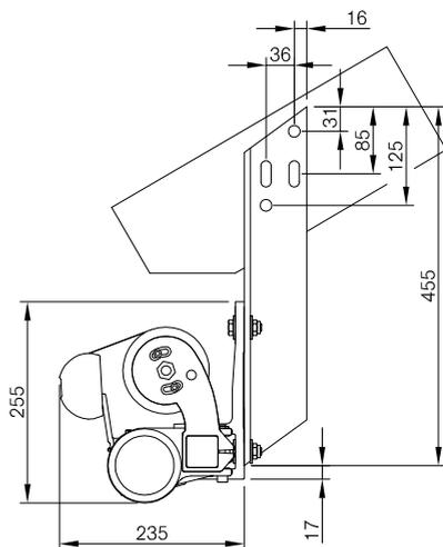
Wählen Sie bei Decken- und Dachsparrenmontage die Positionen der Konsolen so, dass die Vorderkante der Markise mindestens 50 mm hinter der Balkenkante bzw. Dachrinnenkante liegt.
