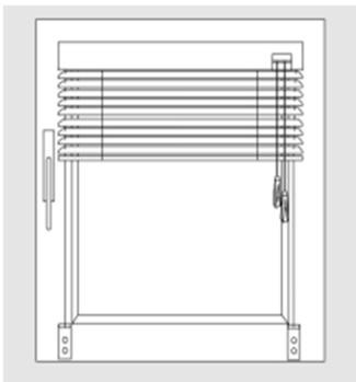
Bei der Montage auf dem Fenster wird das Fensterglas abgedeckt.
