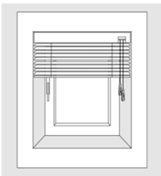
Bei der Montage in der Fensternische wird das gesamte Fenster abgedeckt.
