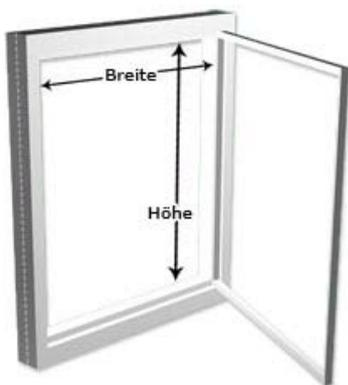
Bei Spannrahmen ohne Falz ist auch bei minimalen Maßen der Fensterrahmen geeignet da er auf dem Rahmen 8 mm aufliegt.
