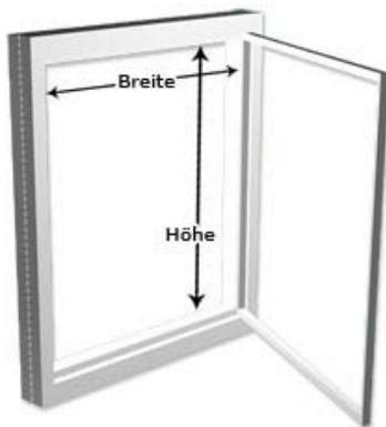
Bei Spannrahmen mit Falz deckt die umlaufende Falz 14mm an jeder Kante ab. Der Spannrahmen schließt fast bündig mit dem Fensterrahmen ab und ist auch mit Rolläden verwendbar. (Aufbauhöhe außen auf dem Rahmen nur 2mm)
